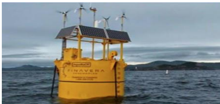
Figura 5 - Absorvedor de ponto da Finavera-Aquabuoy
